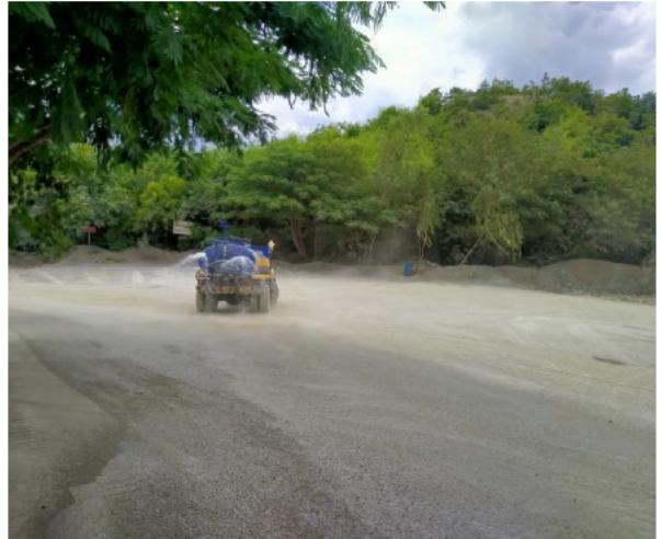
รูปที่ 2-12 การฉีดพรมน้ำบนเส้นทางการลำเลียงแร่ ที่มีการดูแลตลอดเวลา
