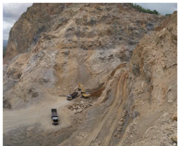
รูปที่ 2-3 (ต่อ) หน้าเหมืองที่มีการทำเหมืองเป็นลักษณะขั้นบันได
