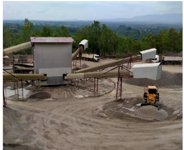
รูปที่ 2-17 (ต่อ) โรงโม่หินของโครงการ มีการปิดคลุมสายพาน
