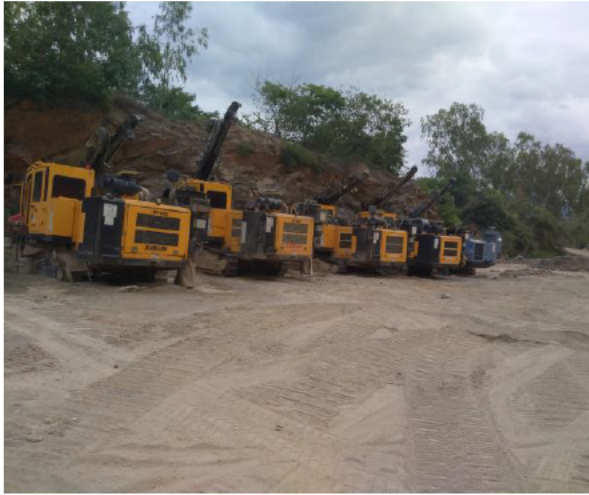
รูปที่ 2-4 เครื่องเจาะรูระเบิดแบบดินตะขามีเครื่องดูดฝุ่นติดตั้งบริเวณหัวเจาะ
