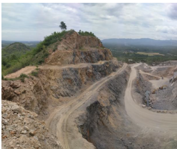
รูปที่ 2-3 หน้าเหมืองที่มีการทำเหมืองเป็นลักษณะขั้นบันได
