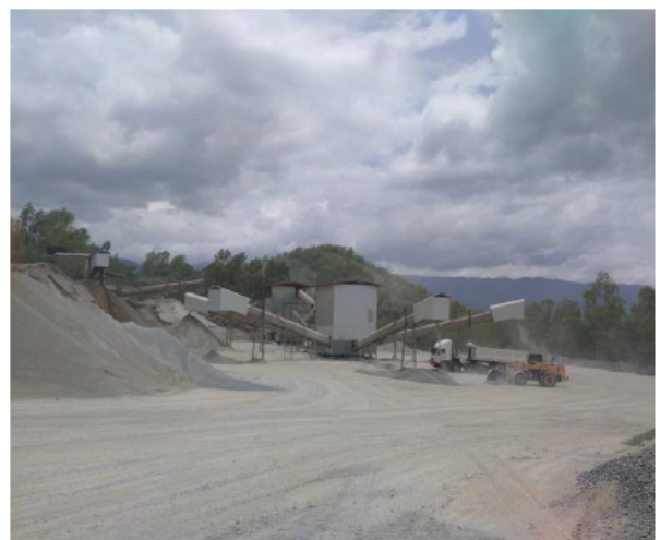
รูปที่ 2-22 พื้นที่เก็บกองหินเป็นลานหินบดอัดแน่น
